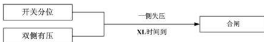
图 4.3-6 单侧失电延时合闸逻辑图
