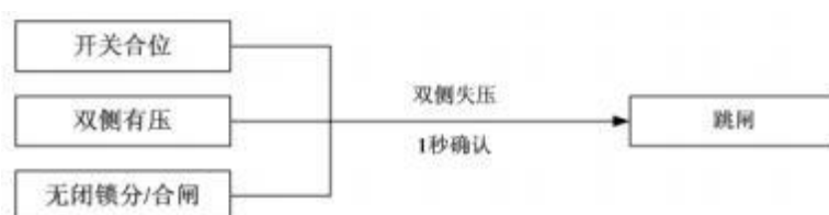
图 4.3-1 失压跳闸逻辑图
